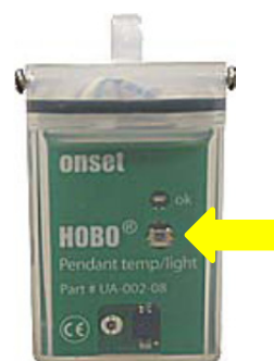
Figura 5. Diseño del luxómetro. La flecha indica el fotosensor.
